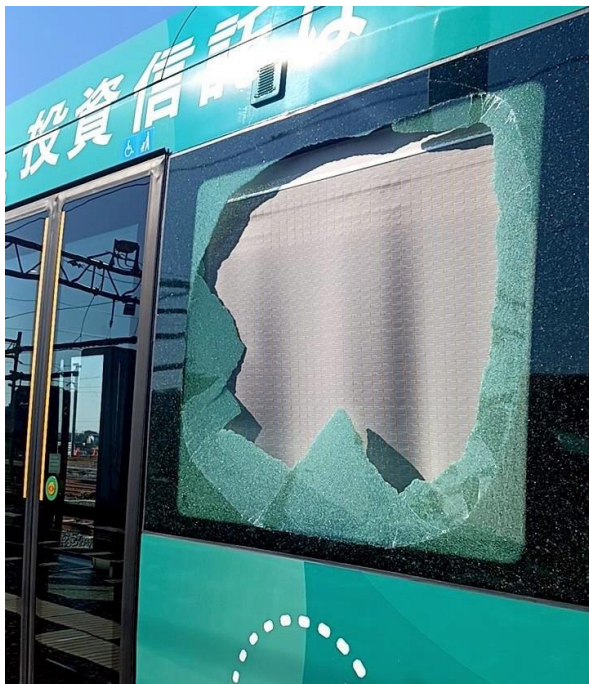
【破損した窓ガラス】
